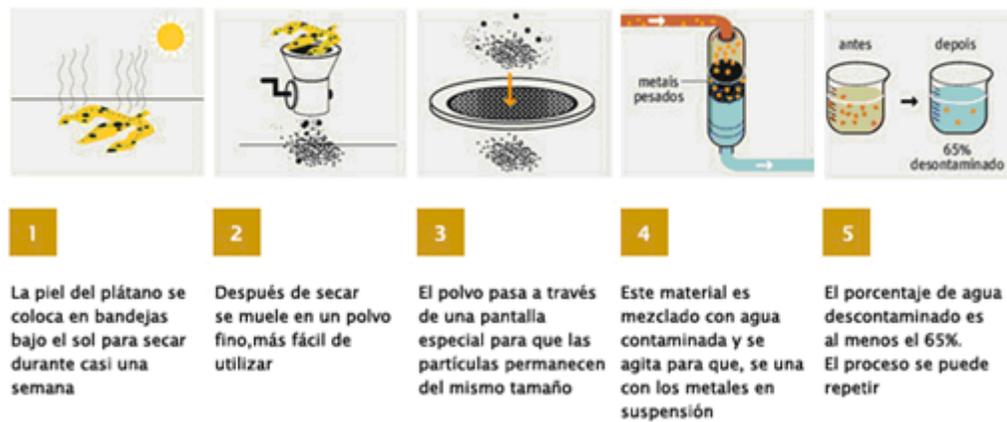
Fig. 1. Proceso de limpieza a través del uso de la piel de plátano
