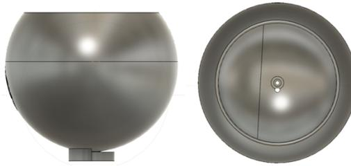
Fig. 1. Imagen izquierda, vista de canto. Imagen derecha, vista frontal de la esfera integradora. Los puertos están sobre el mismo eje central, al fondo los puertos del fotodetector y abajo corresponde a la fuente de luz.
