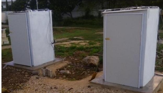
Figura 1. Casetas de prueba con las láminas de prueba (lámina espreado con poliuretano y lámina Ultralam) instaladas y listas para el experimento de evaluación térmica.
