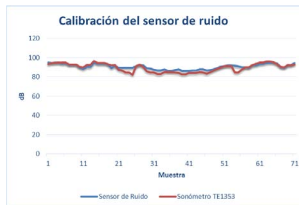
Figura 2. Análisis comparativo entre el sensor de ruido y el sonómetro TE1353.
