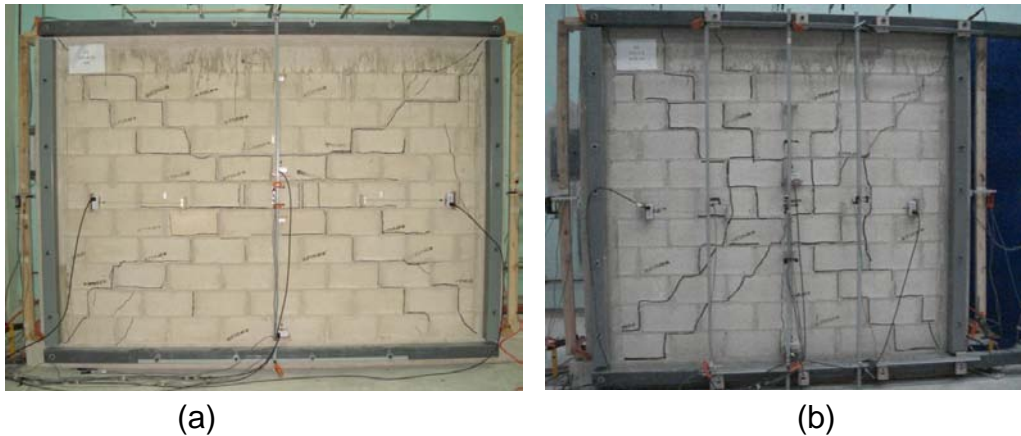
Figura 1 Patrón de agrietamiento final del muro con (a) relación de aspecto menor (E-1) y (b) relación de aspecto mayor (E-2)
