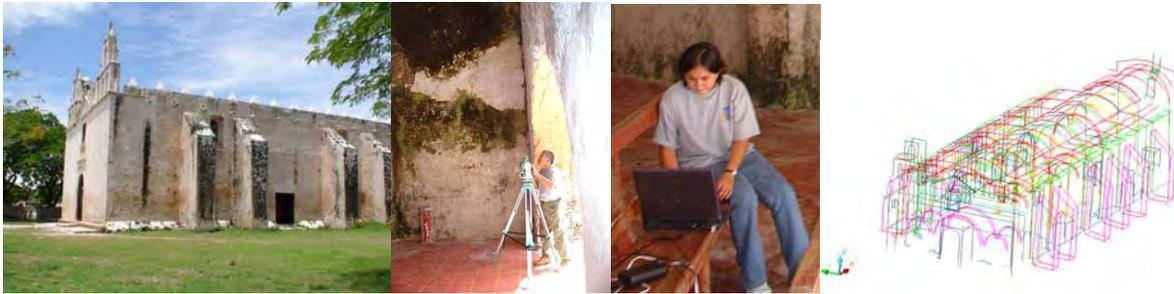
*Figura 1. Proceso de digitalización de las estructuras a) Modelo real b) Medición c) captura d) modelo tridimensional en formato Cad.*
